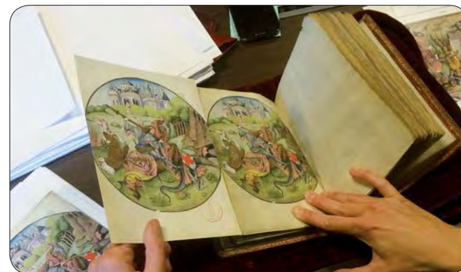
Ejemplo de las distintas fases de control de la cromía con el original: control de las pruebas de color y anotación de correcciones para una mayor exactitud, y comprobación final de la lámina de prueba.
