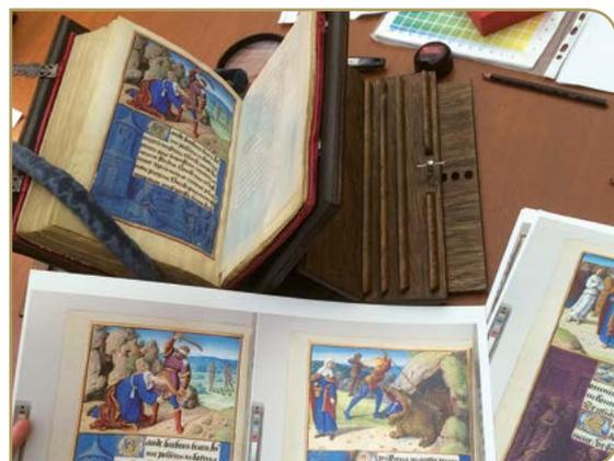
Exemplo das diferentes fases de controlo da tonalidade com o original: controlo dos testes de cor e registo das correções para uma maior precisão.
